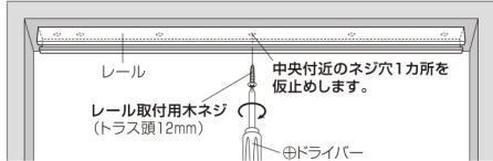
③ 仮止めされた部分を中心にレールを回転させて、パネルドア本体に付いているランナーのローラー部分をレールの溝に入れて本体をセットしてください。
