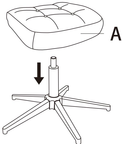
(2) ステップ1で組み立てた脚部のガスシリンダーの先端に、矢印の向き(下向き)に従って、部品A(座面)の裏側にある穴を上から差し込んでください。
