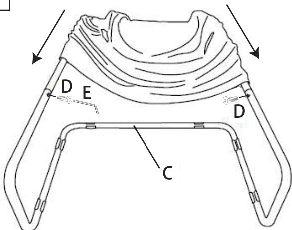
(3) 座面を通したフレームの端を、部品C(フレーム)にある差し込み口に差し込みます。
