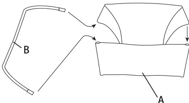
(1) 部品A(座面)の両端にある筒状の部分に、座面B(フレーム)をそれぞれ差し込みます。
