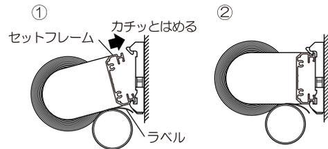
窓枠の内側・カーテンレールに取付ける場合
